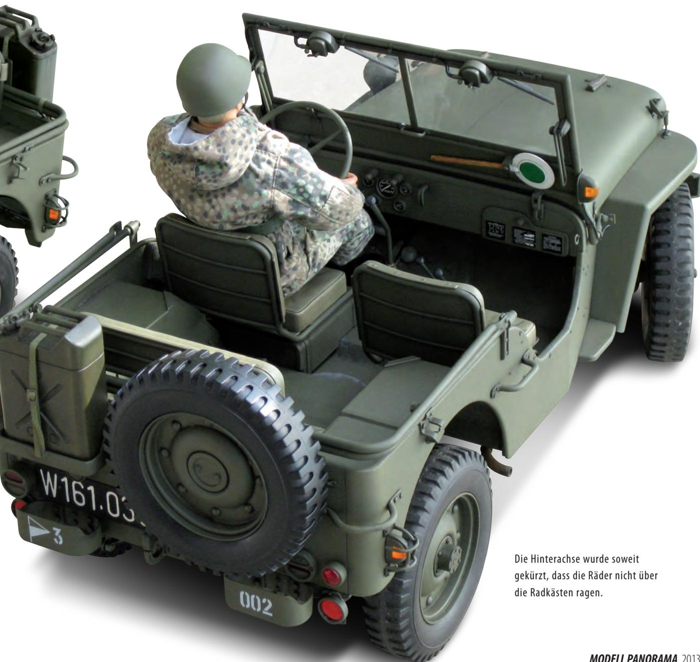
Die Hinterachse wurde soweit gekürzt, dass die Räder nicht über die Radkästen ragen.
